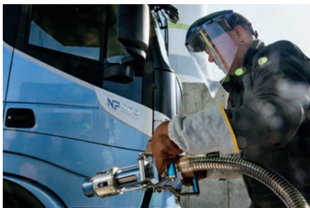
Para el repostaje, hay que aprender unos sencillos pasos y tener en cuenta las bajas temperaturas a las que se carga el gas.
